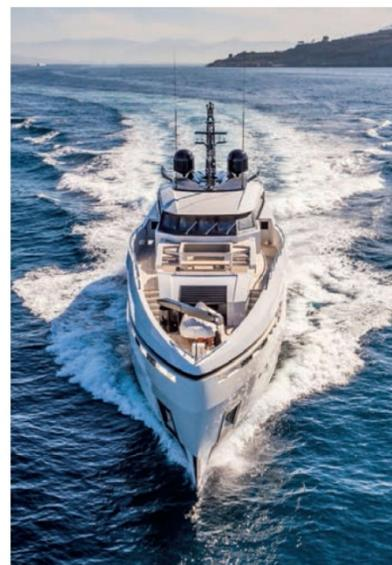
Il *Columbus Sport Hybrid Divine*: lungo 40 metri, è uno yacht in alluminio semiplanante con sistema di propulsione ibrida.
